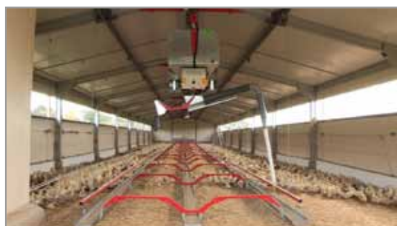
DAPAG Futterautomaten in hochklappbaren Trögen für Geflügel
