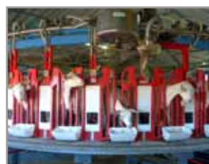
← Plateforme rotative de traite intérieur de 30 à 56 places.
